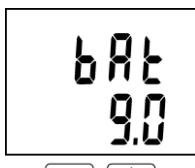
Zobrazuje se orientační hodnota napětí částečně zatížené baterie. Z této hodnoty lze posoudit stav baterie.
