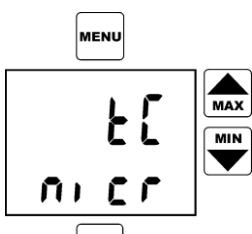
Pro nastavení typu termočlánku je nutno z menu vybrat položku tC (zobrazení typu termočlánku, pro jehož měření je přístroj momentálně nastaven) a volbu potvrdit klávesou ENTER.
