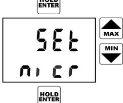
Nápis Set indikuje režim nastavení typu termočlánku. Klávesami se šipkami nahoru/dolů lze na dolním řádku displeje nastavit požadovaný typ termočlánku – J, nicr (tj. termočlánek K) nebo S. Stiskem klávesy ENTER je nastavený typ termočlánku potvrzen. Beze změny nastavení lze tento režim opustit stiskem klávesy MENU.
