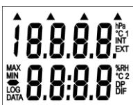
Před zapnutím přístroje je nutno připojit do konektorů (T1, T2) teplotní sondy (je možné připojit jen jednu sondu). Přístroj se zapíná stiskem klávesy ON/OFF. Po zapnutí se na okamžik rozsvítí všechny znaky displeje pro jeho případnou kontrolu. Je-li klávesa ON/OFF při zapnutí přidržena stisknuta, svítí všechny znaky displeje až do uvolnění klávesy ON/OFF.
