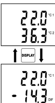
Na horním řádku displeje se zobrazuje teplota 1. kanálu T1 ( $^{\circ}\text{C}$  1), na dolním řádku teplota 2. kanálu T2 ( $^{\circ}\text{C}$  2)
