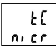
Při běžném provozu se poté na displeji krátce zobrazí typ termočlánku, pro jehož měření je přístroj momentálně nastaven, tzn. symboly **J** nebo **nier** (termočlánek K) nebo **S**. Neodpovídá-li nastavení přístroje typu připojené sondy, budou zobrazované údaje o teplotě nesprávné a je nutné přístroj nastavit pro zvolený typ termočlánku (popis viz dále).
