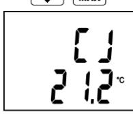
Zobrazuje se teplota studeného konce termočlánku, měřená v místě konektoru tepletovní sondy. Tato teplota je použita pro automatickou kompenzaci studeného konce termočlánku.
