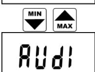
Indikuje zapnutí (On) nebo vypnutí (OFF) akustické signalizace překročení hranic alarmů. Stiskem klávesy ENTER lze aktuální stav změnit v opačný. Upozornění: je-li baterie už slabá, akustická signalizace z důvodu omezení odběru proudu nepracuje a to nezávisle na nastavení této volby.
