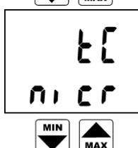
Zobrazuje se typ termočlánku, pro jehož měření je přístroj momentálně nastaven, tzn. symboly **J** nebo **nict** (termočlánek K) nebo **S**. Stiskem klávesy ENTER lze vstoupit do režimu nastavení typu termočlánku (popis nastavení viz dále). Neodpovídá-li nastavení přístroje typu připojené sondy, budou zobrazované údaje o teplotě nesprávné !
